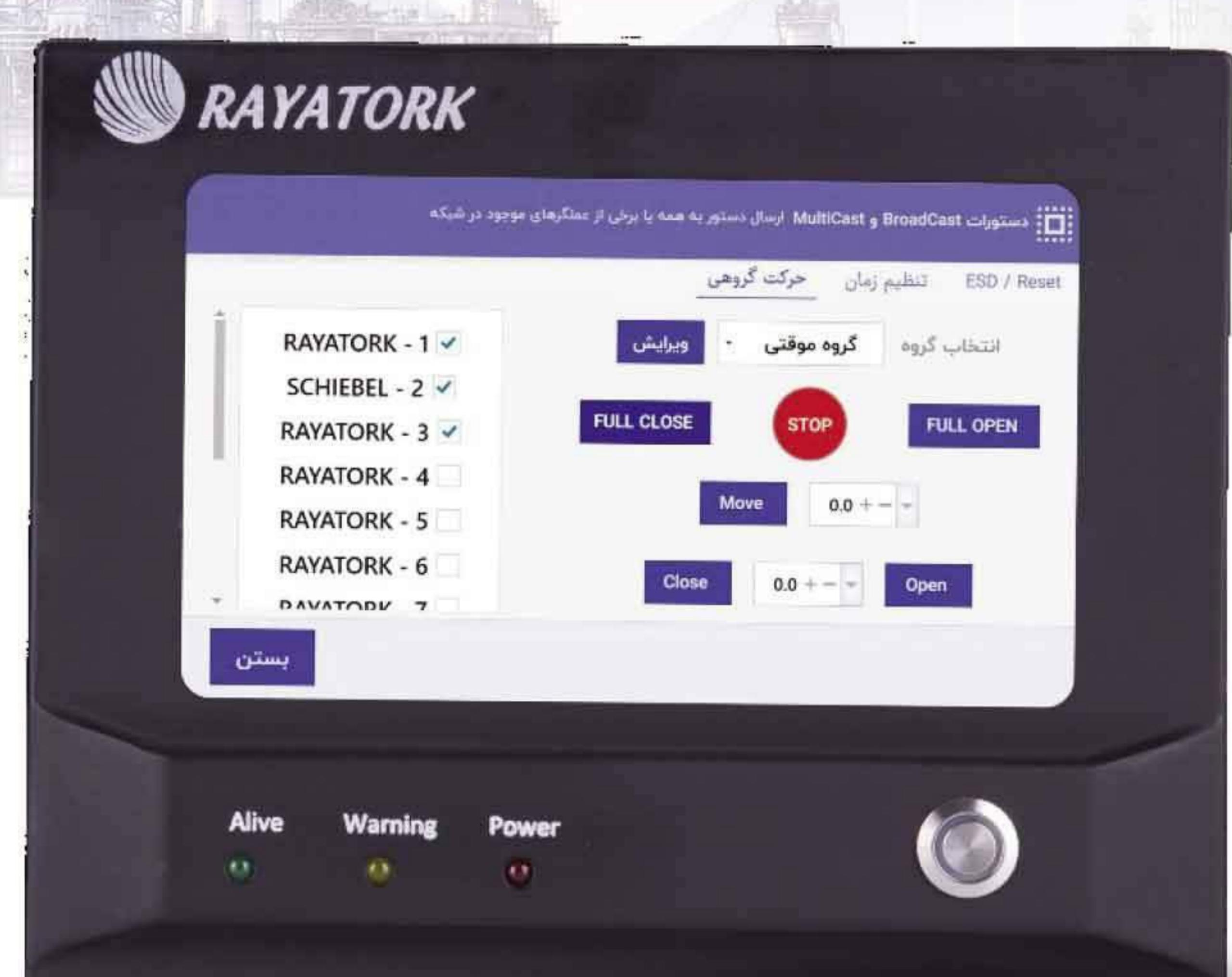
در راستای افزایش کارامدی در عین سادگی، در رابط کاربری RayaMaster برخی از قابلیت‌ها خلاصه شده و در عوض پورت Ethernet جهت اتصال به سیستم WorkStation و توسعه قابلیت‌ها بر روی یک سیستم دسکتاپ جداگانه در قالب نرم افزار RayaMasterHost فراهم شده است. از جمله قابلیت‌های نرم افزار RayaMasterHost استخراج پروفایل گشتاور در Laptop و WorkStation است. در رابط کاربری RayaMaster امکان مشاهده لحظه‌ای گشتاور برای هر عملگر وجود دارد.
