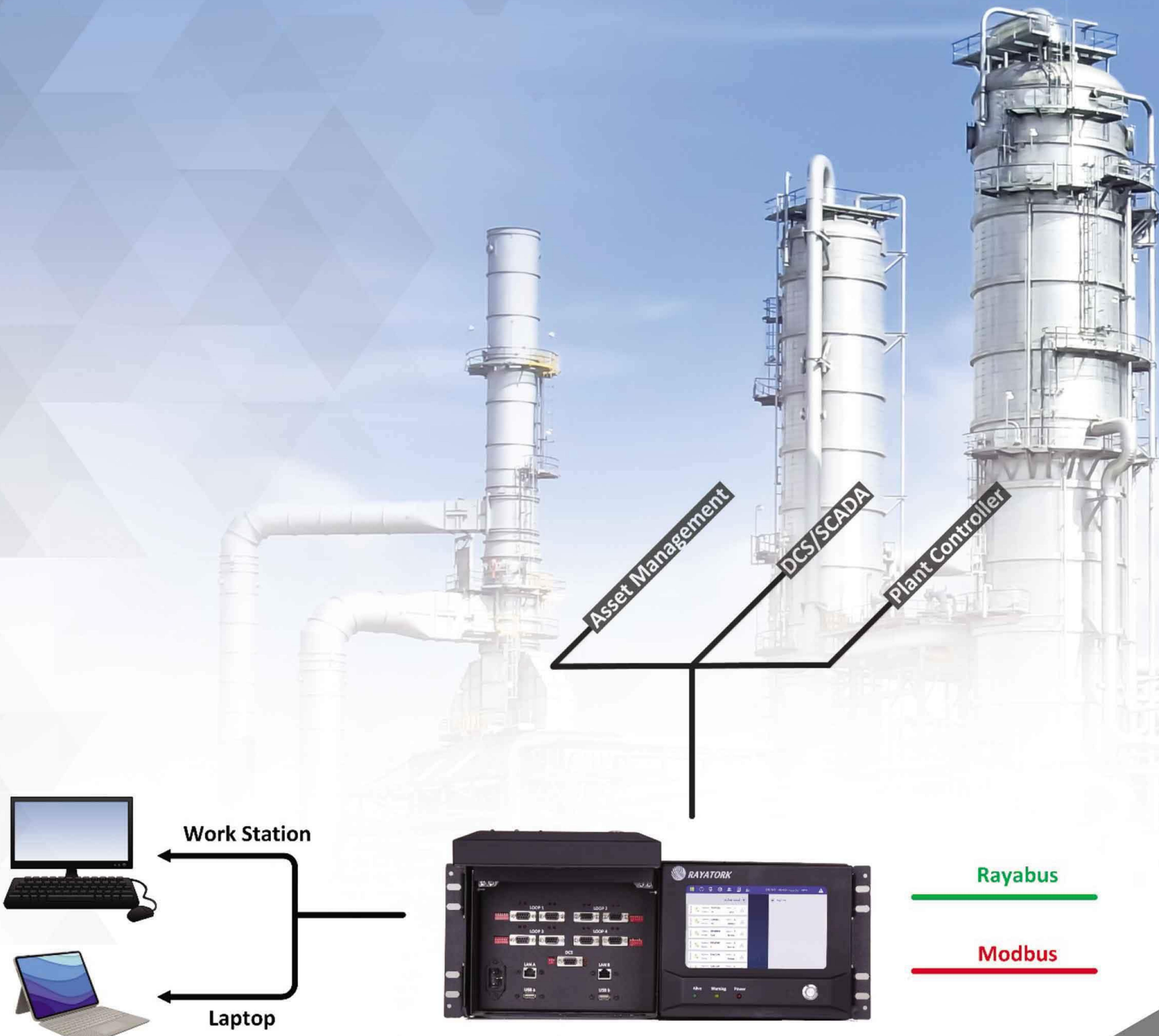
دارای یک صفحه نمایش لمسی بزرگ RayaMaster است و اپراتور یا مهندسین می‌توانند از طریق آن متوجه شوند که برای عملگرهای داخل فیلد چه اتفاقی در حال رخ دادن است. همچنین امکان ارسال دستور برای عملگرها و دریافت پاسخ وجود دارد.
